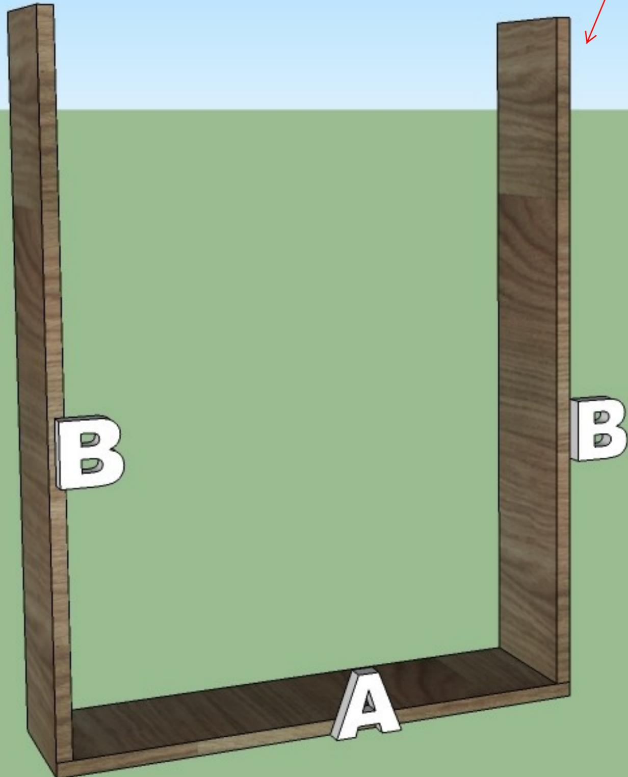
Vissez les pièces B avec une pièce A, et insérez les plaques de plexiglass en les faisant glisser dans les rainures.
