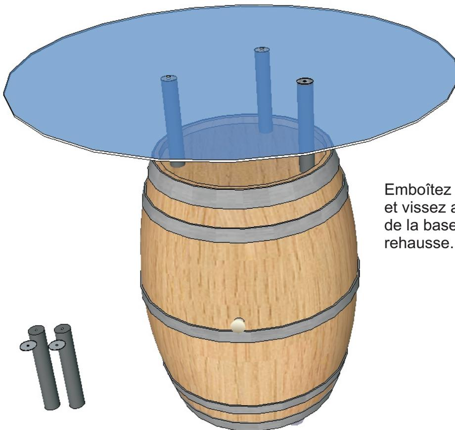
Emboîtez les pieds acier sur les bases et vissez avec une clé à laine la vis noire de la base des pieds pour bloquer la rehausse.
